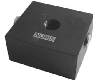
Der Druckaufbau wird mittels fest angeschlossener Ölpumpe oder Hydraulikaggregat eingeleitet. Das Medium fließt in die planseitig vorhandene Ringnut und bewegt die Nutringdichtung und den Ringkolben. Der Systemdruck in der Spannmutter lässt sich am Manometer des Druckerzeugers präzise ablesen. Der Druckabbau erfolgt direkt über das angeschlossene Druckerzeugersystem. Der Ringkolben mit der Spannmutter wird zur Gegenfläche gedrückt. Das Medium fließt zurück in das Druckerzeugersystem.
