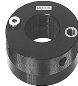
Der Druckaufbau wird mittels fest angeschlossener Ölpumpe oder Hydraulikaggregat eingeleitet. Das Medium fließt in die planseitig vorhandene Ringnut und bewegt die Nutringdichtung und den Ringkolben. Der Systemdruck in der Spannmutter lässt sich am Manometer des Druckerzeuger präzise ablesen. Der Druckabbau erfolgt direkt über das angeschlossene Druckerzeugersystem. Der Ringkolben mit der Spannmutter wird zur Gegenfläche gedreht. Das Medium fließt zurück in das Druckerzeugersystem.
