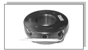
Der mitgelieferte Stiftschlüssel wird verwendet, um die Druckschrauben in den Mutternkörper einzudrehen. Das Medium fließt in die planseitig vorhandene Ringnut und bewegt die Nutringdichtung und den Ringkolben.
