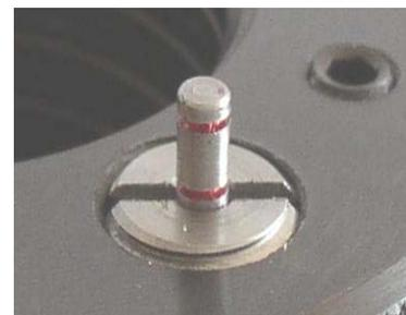
Die Druckanzeige dient zur einfachen Darstellung des vorhandenen Systemdruckes in der Spannmutter. Mittels der Markierungen an der Druckanzeige kann die Spannkraft abgeleitet werden.
