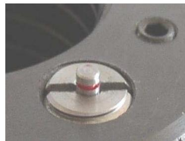
Die Druckanzeige ist bis zur 2. Markierung ausgefahren.
