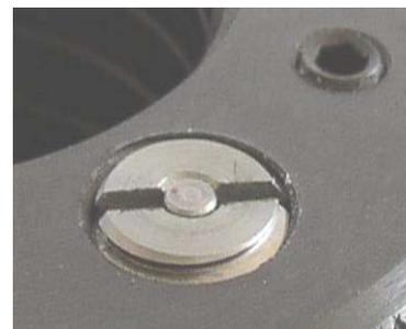
Die Druckanzeige ist sichtbar bis zur 1. Markierung ausgefahren.
